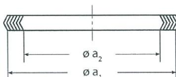
• Joints spiralés V1 pour brides à emboîtement double PN 10-16-25-40-(64)-100 suivant norme NF E 29-203 et/ou NF EN 1092-1
